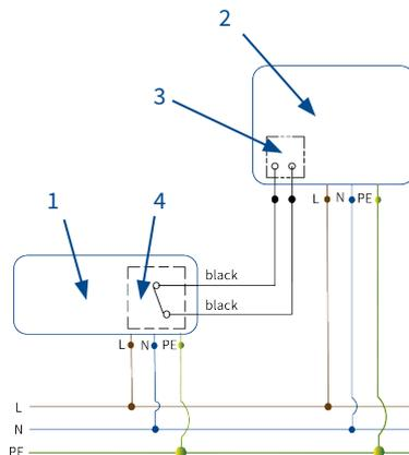
Wenn das Kühlgerät kein Kontrollelement enthält, kann ein anderes Kontrollgerät oder der Alarmkontakt, wie hier dargestellt, angeschlossen werden.
